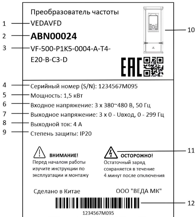
Рисунок 1.3-1 – Пример маркировки преобразователя частоты
