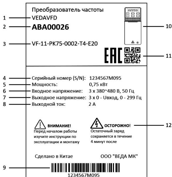
Рисунок 1.3-1 – Пример маркировки преобразователя частоты
