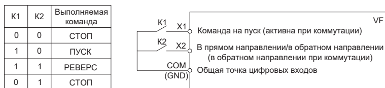
Рисунок 10.9-6. Двухпроводная схема управления 2
