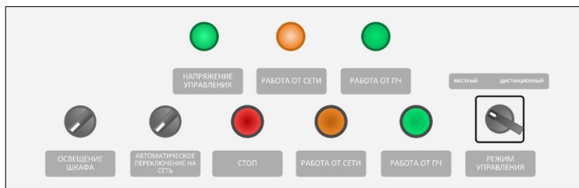
Рис. 6.8 - Панель управления системы автоматического байпаса
