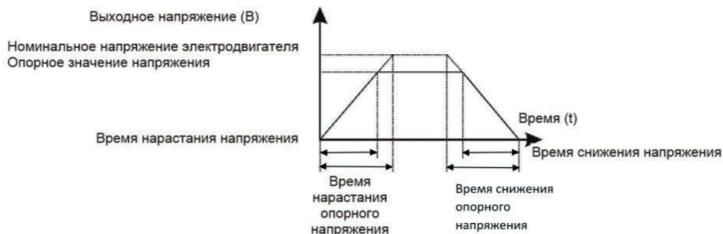
Рис.6.8 Время нарастания и снижения напряжения
