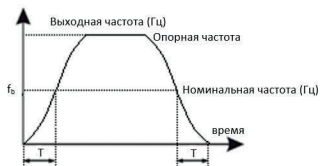
Рис. 6-3 Кривая S разгона/торможения В
