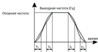
Рис. 6-2 Кривая S разгона/торможения А
