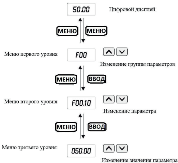
Рис. 6.1 Схема настройки параметров меню
