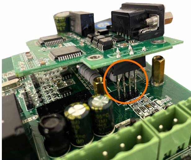
Рисунок 9 – Установка платы расширения SNI-DP-S к плате управления SNI
