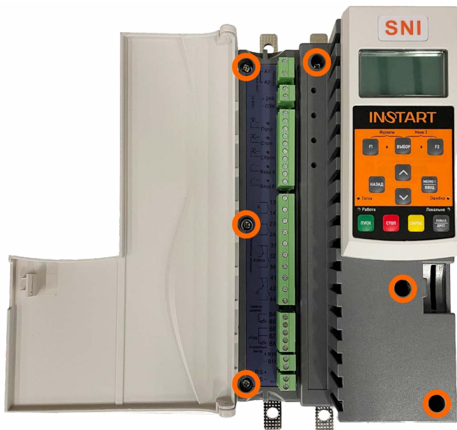
Рисунок 15 – Винты крепления корпуса устройства плавного пуска
