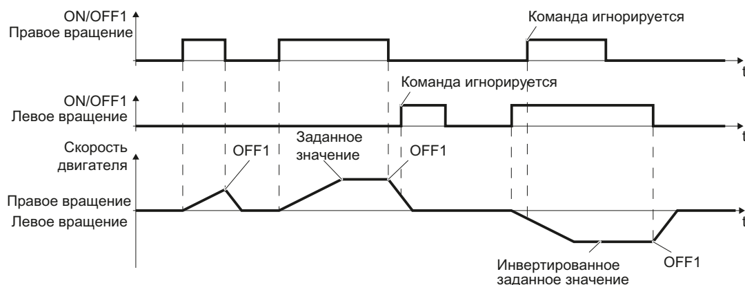
Изображение 8-3 Двухпроводное управление, метод 2
