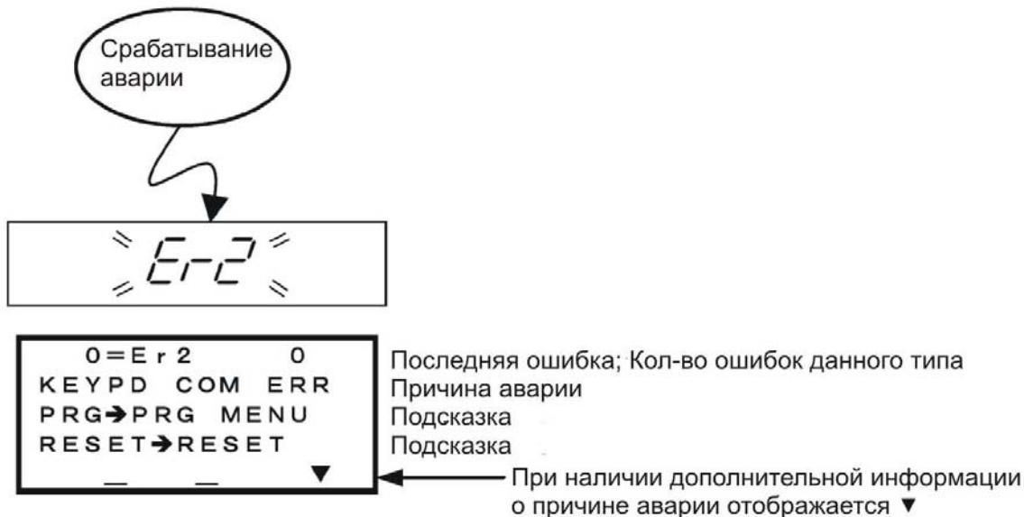
Рис. 3.38 Индикация без перекрывающейся аварии
