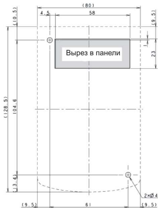
Размеры выреза в панели (со стороны вида А)
