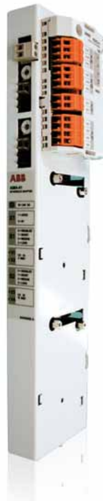
Блок расширения входов/выходов AIMA-01
