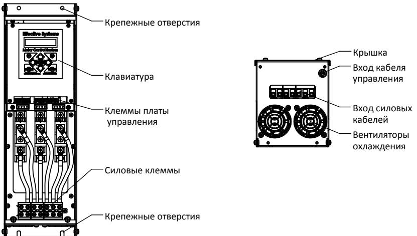
Рис. 1.3 Составные части контроллера номинальной мощностью 30 - 37 кВт
