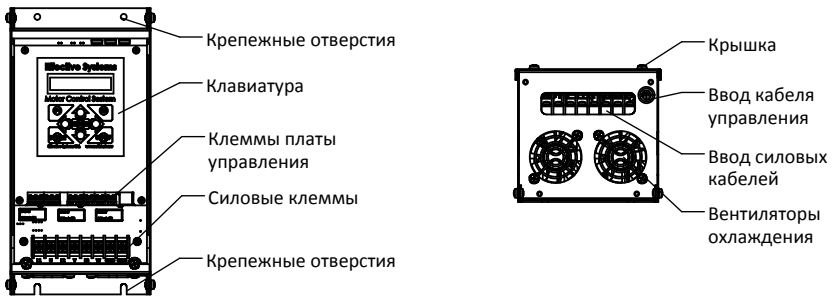
Рис. 1.1 Составные части контроллера номинальной мощностью 5,5 - 11 кВт
