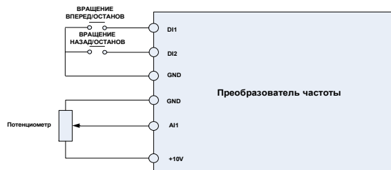
Рисунок 4. Схема подключения цепи управления
