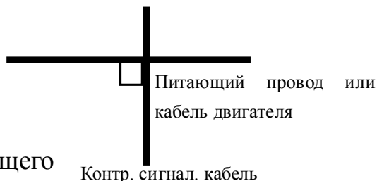
Рис.3-21 Требования к подключению системы
