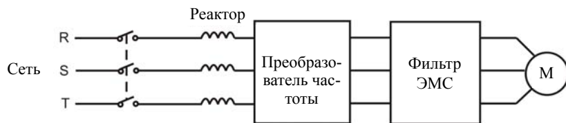
Рис. 4.10 Подключение выходных цепей
