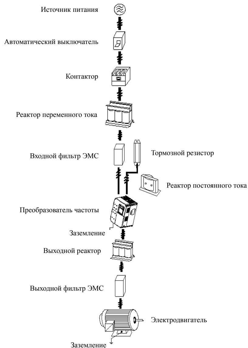
Рис. 4.1 Подключение дополнительных устройств
