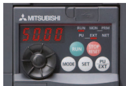
Встроенная панель управления с поворотным пультом управления
