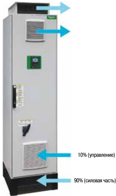
Система охлаждения с разделением потоков воздуха
