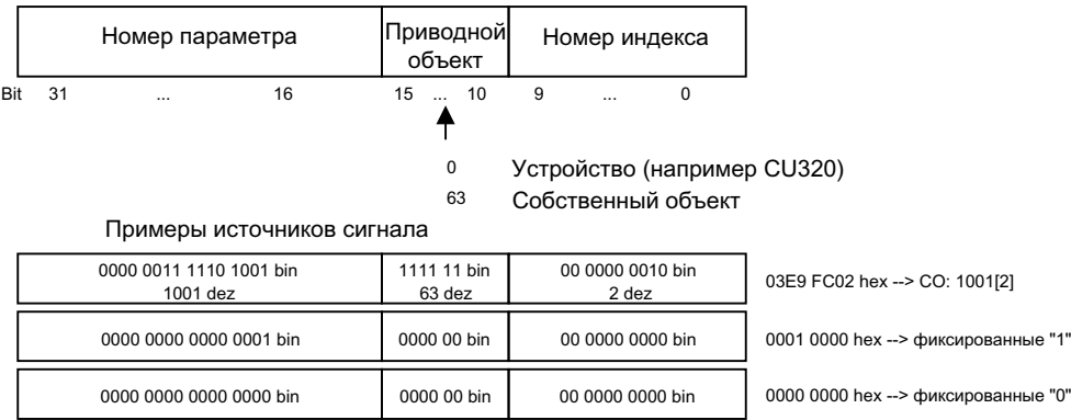
Изображение 6-6 Внутренняя кодировка параметров бинекторных/коннекторных выходов
