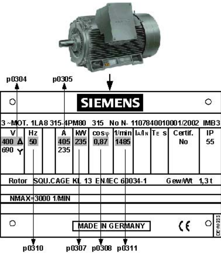
Изображение 5-41 Пример фирменной таблички двигателя
