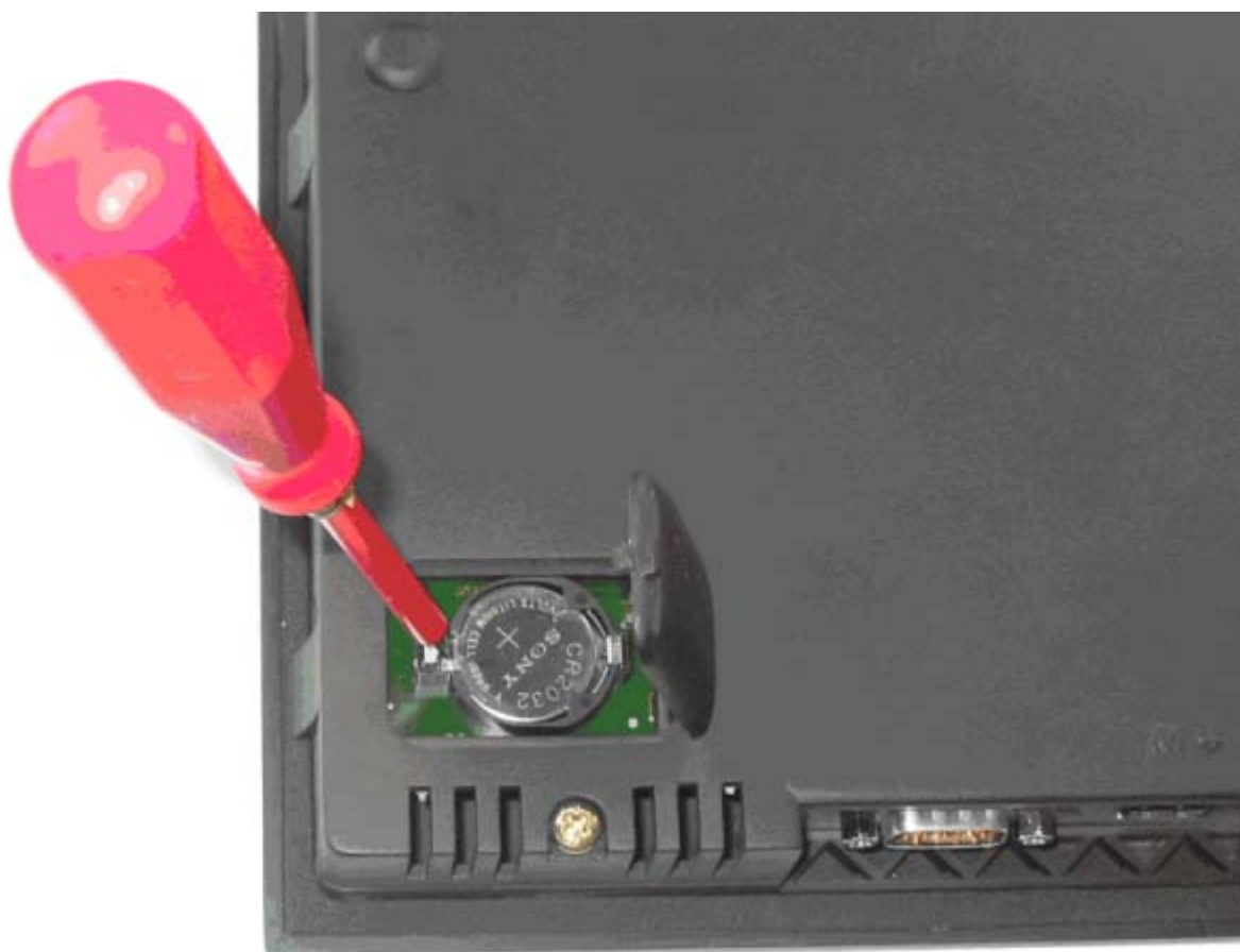
Изображение 11-25 Замена буферной батареи на панели управления шкафа.
