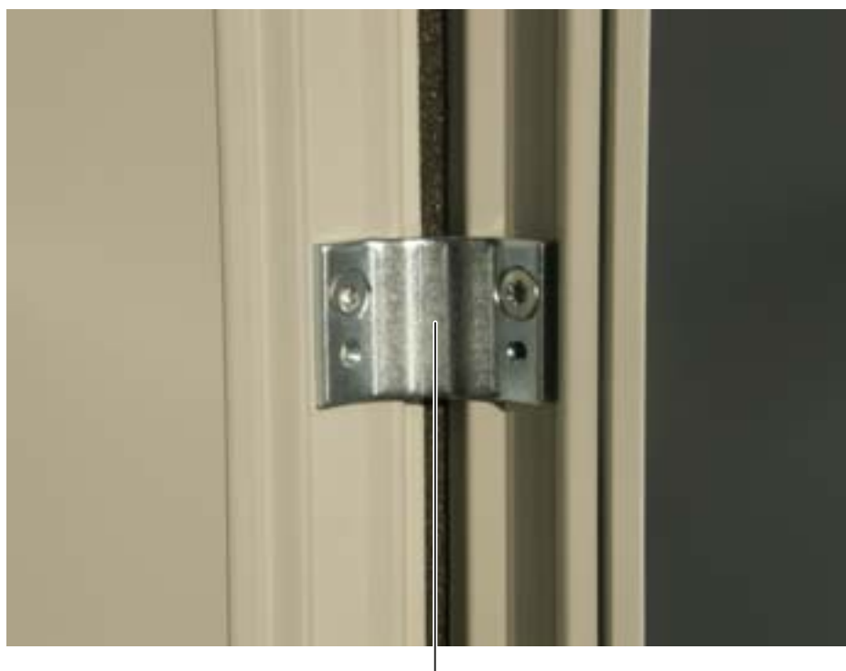
Наружная шкафная стяжка Момент затяжки: 9 Нм
