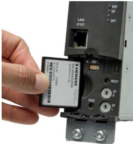
Изображение 4-21 Слот для карты CompactFlash
