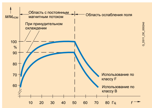
Типовое изменение допустимого крутящего момента двигателей с естественным охлаждением (например, 1LG / 1LA) с номинальной частотой 50 Гц
