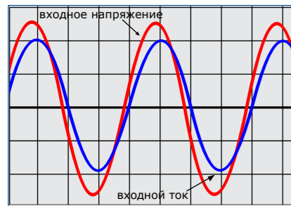
типичная форма кривой входного тока и напряжения
